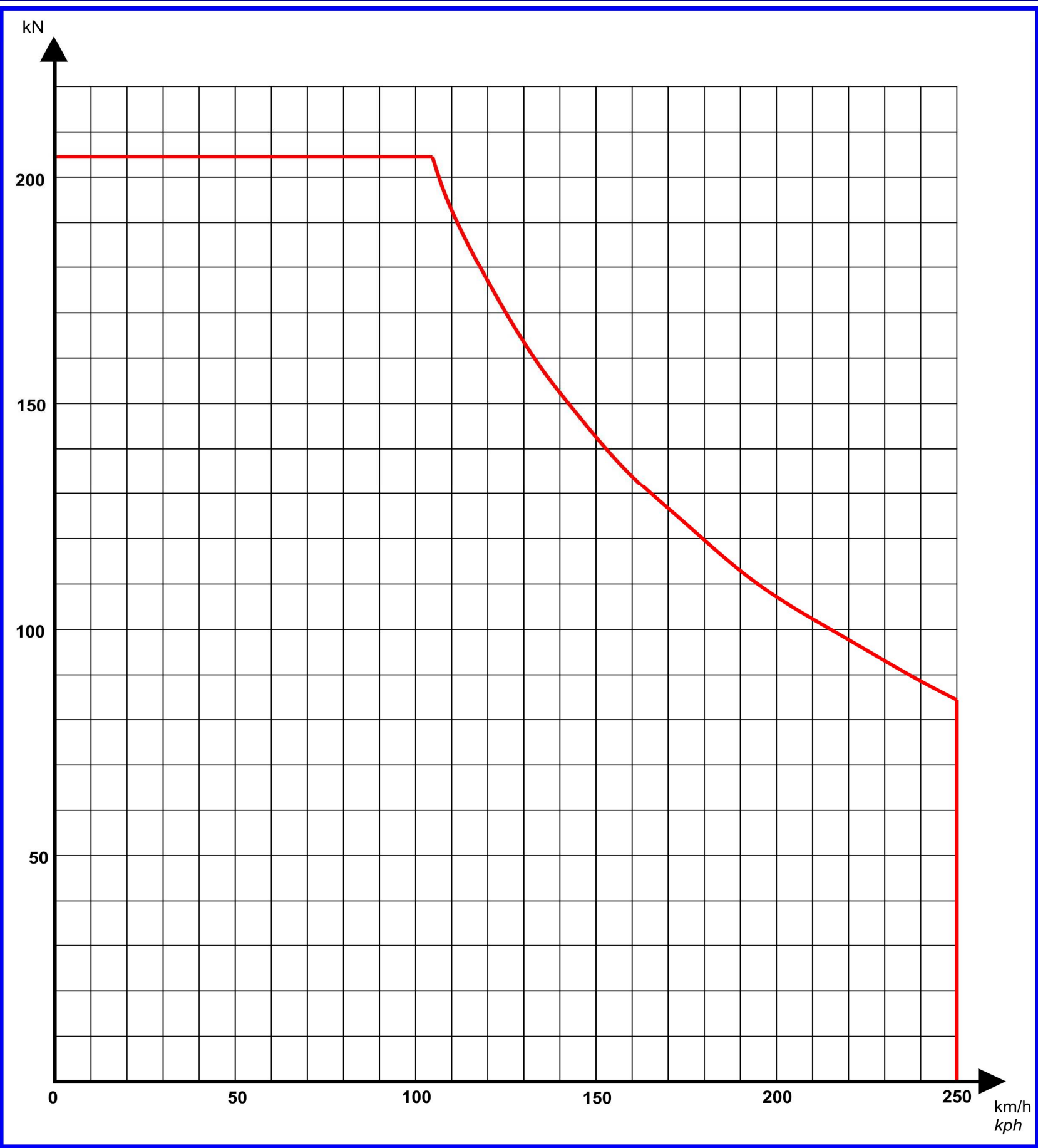
Caractéristique effort-vitesse en traction Force vs speed tration characteristics
