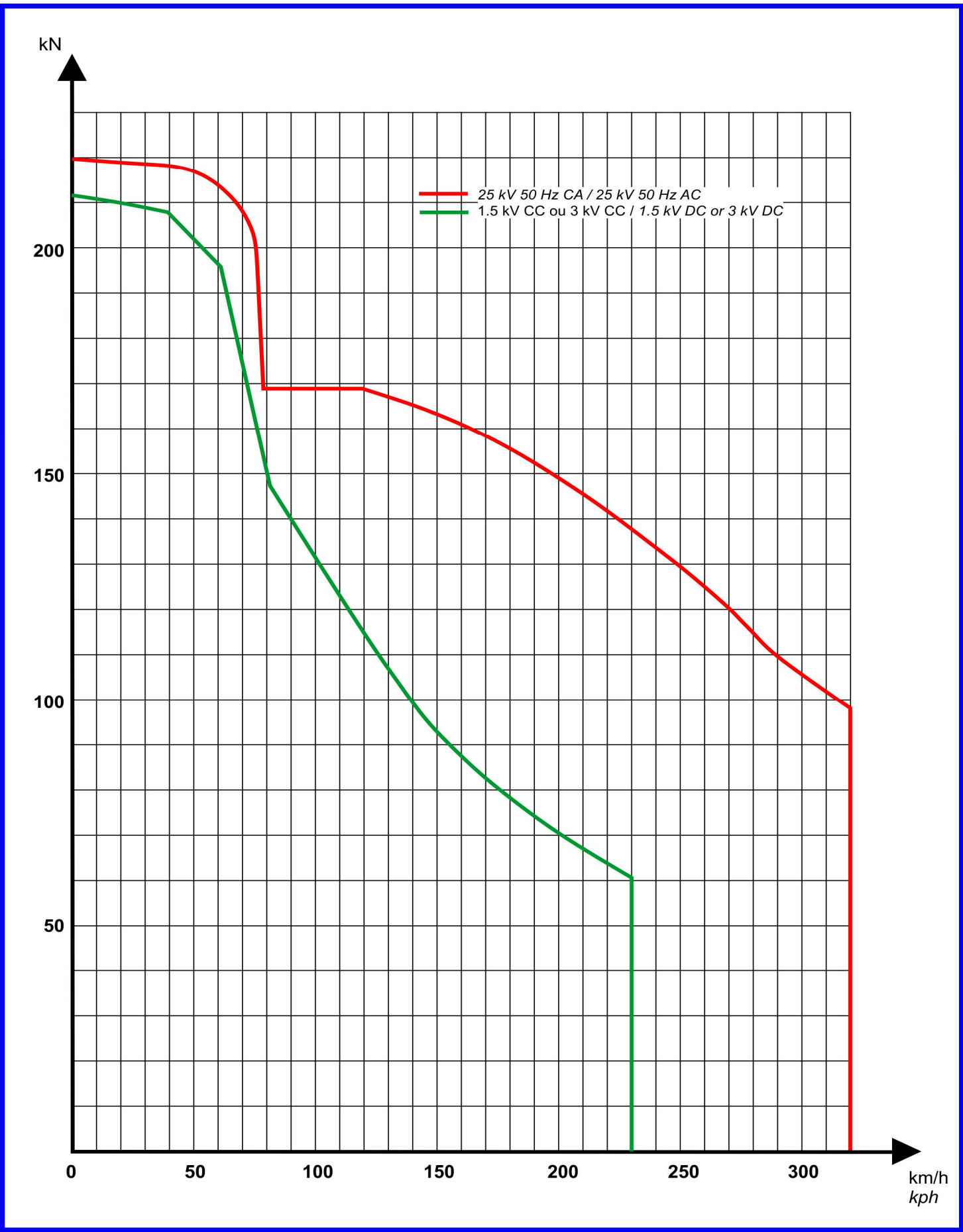
Caractéristique effort-vitesse en traction Force vs speed tration characteristics
